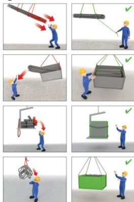
Slika 18: Varno delo z dviznimi napravami
